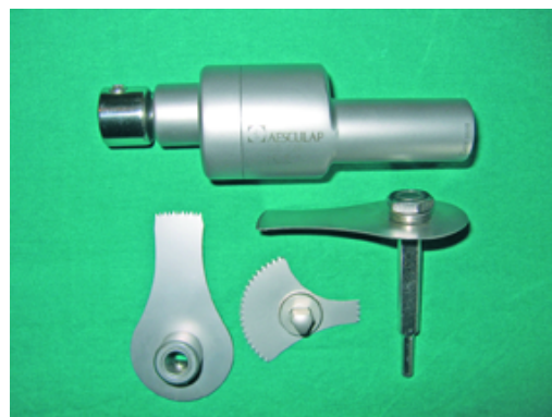
Abb 2 Oszillierende Säge Aesculap GB 128 mit verschiedenen Sägeblättern, passend auf ELCOMED 100 Antriebs-einheit. Oscillating saw Aesculap GB128 with different saw blades attaching to ELCOMED 100 power unit.
